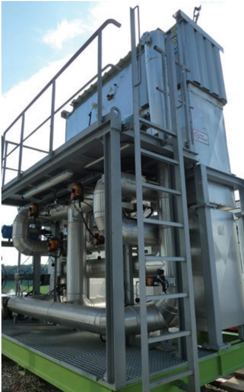
RTO Pilot-Testanlage (regenerativ thermische Oxidation)
