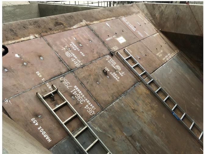
Einfülltrichter mit neuen Verschleissplatten
