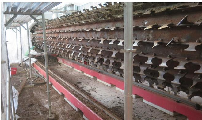
rotor du sécheur avec les racleurs
